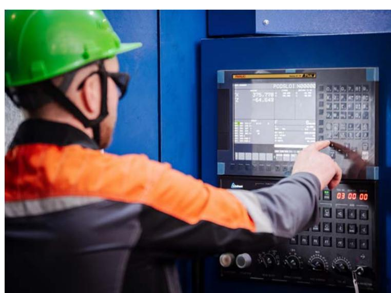
◀ После того, как валок восстановлен с помощью наплавочного агрегата, приходит черед запрограммировать его чистовую обработку на новом станке
