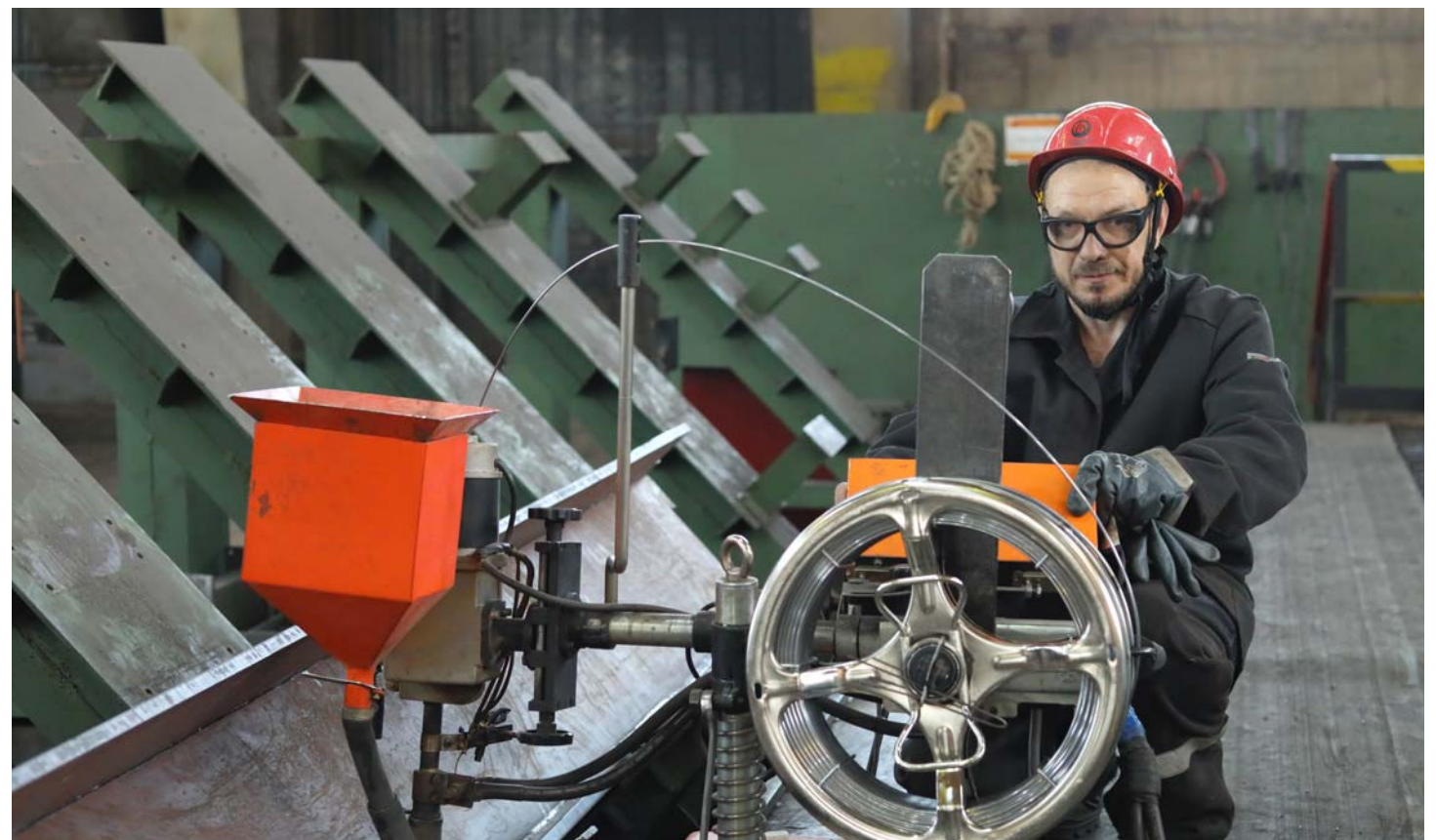
▲ Почему агрегат автоматической сварки под флюсом в ЦМК называют «трактором», и для чего он нужен — читайте в ближайших номерах «Металлурга»
