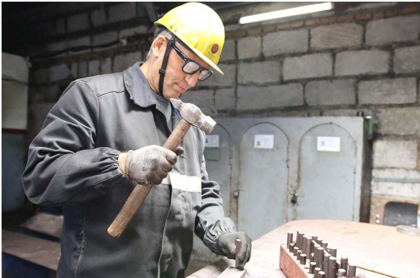
▲ Каждая идущая в лабораторию проба получает уникальный идентификатор, который пока набивают вручную, но рано или поздно одним из следующих витков цифровизации станет автоматизация и этого процесса
