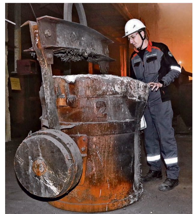
▲ Для небольшого объёма металла в ковше очень важно удерживать температуру, пригодную для разлива. Инженеры ФЛЦ решили эту задачу
