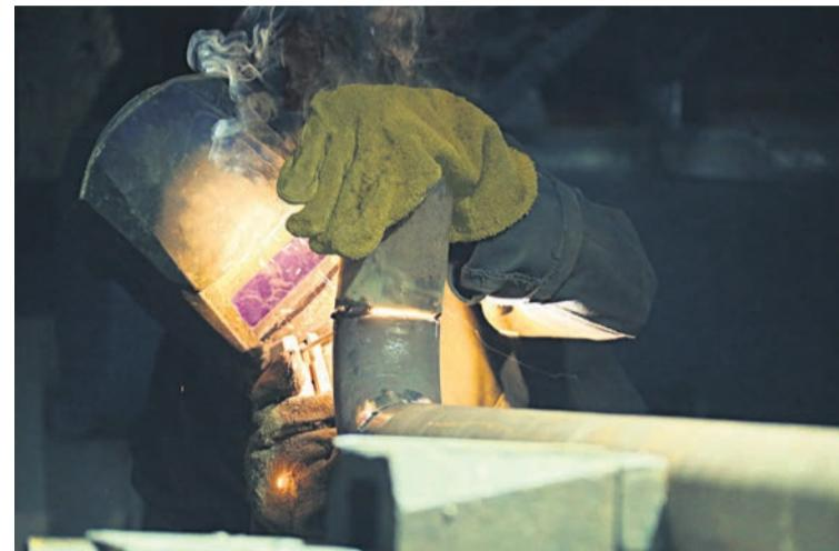
▲ Котёл-утилизатор содержит разветвлённую сеть трубопроводов, и качество сварного шва во много определяет срок службы всего агрегата
