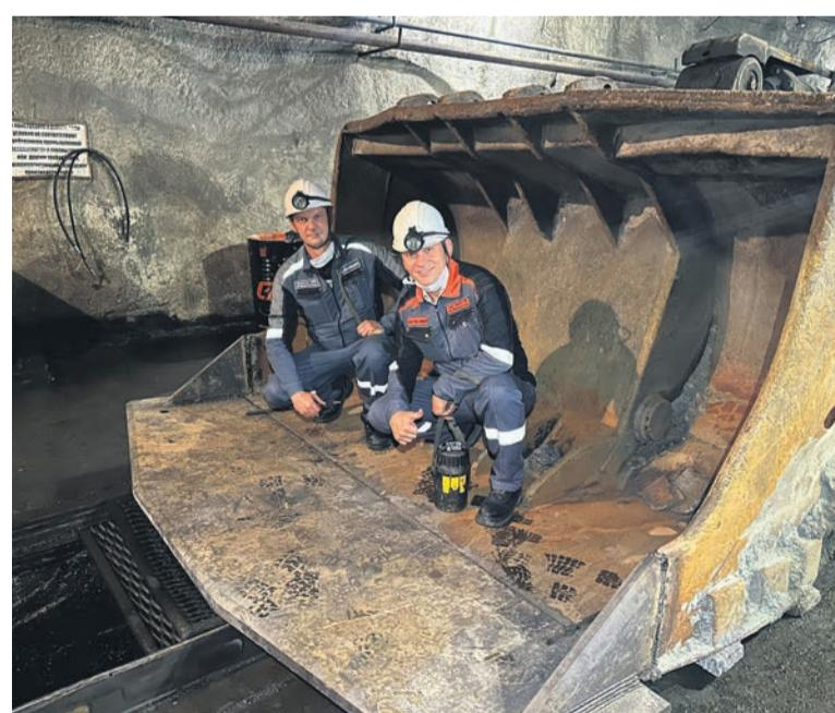
▲ Самую большую нагрузку фронтального погрузчика на режущую кромку ковша, теперь взяла на себя износостойкая сталь из Новотроицка
