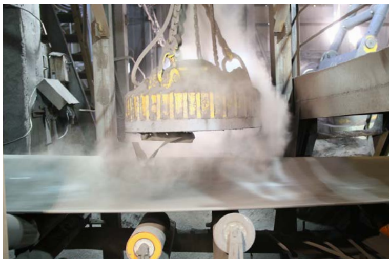
▲ Электромагнит на конвейере — страж производства: он мгновенно отсекает металлические включения, защищая ленту от порезов и предотвращая дорогостоящие простои
