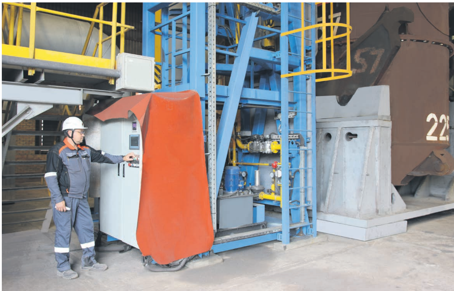
▲ У стенда сушки и разогрева предусмотрен и ручной режим работы, однако приоритет отдан автоматике, которая отлично справляется с задачей
