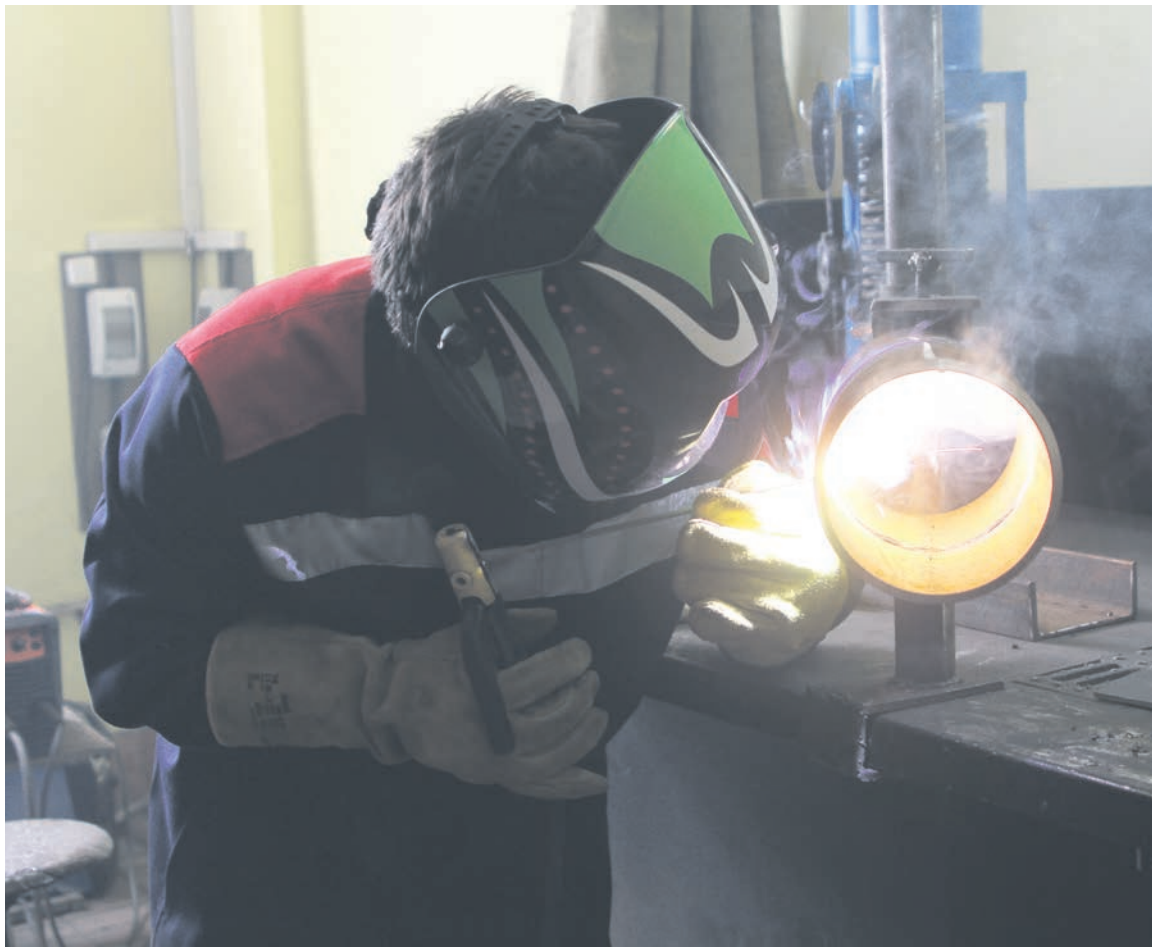
▲ Чтобы наложить змееобразный шов, опытные сварщики используют обе руки: одна отвечает за «держак», вторая прокладывает скрепляющую детали извилистую линию
