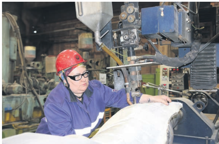
▲ Теперь даже достаточно длинный перерыв не повлияет на качество шва: одно укрывающее движение — и деталь будет хранить тепло часами
