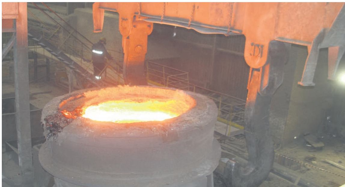
▲ Прежде, чем стать сталью, металл проходит через несколько этапов доводки: раскисление, легирование и при необходимости — вакуумирование
